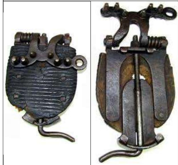
Patente de 1896- Crampones adaptables a cualquier tamaño del zapato, con los tacos que pueden levantarse detrás del tacón cuando no se necesitan para caminar sobre superficies no heladas.
