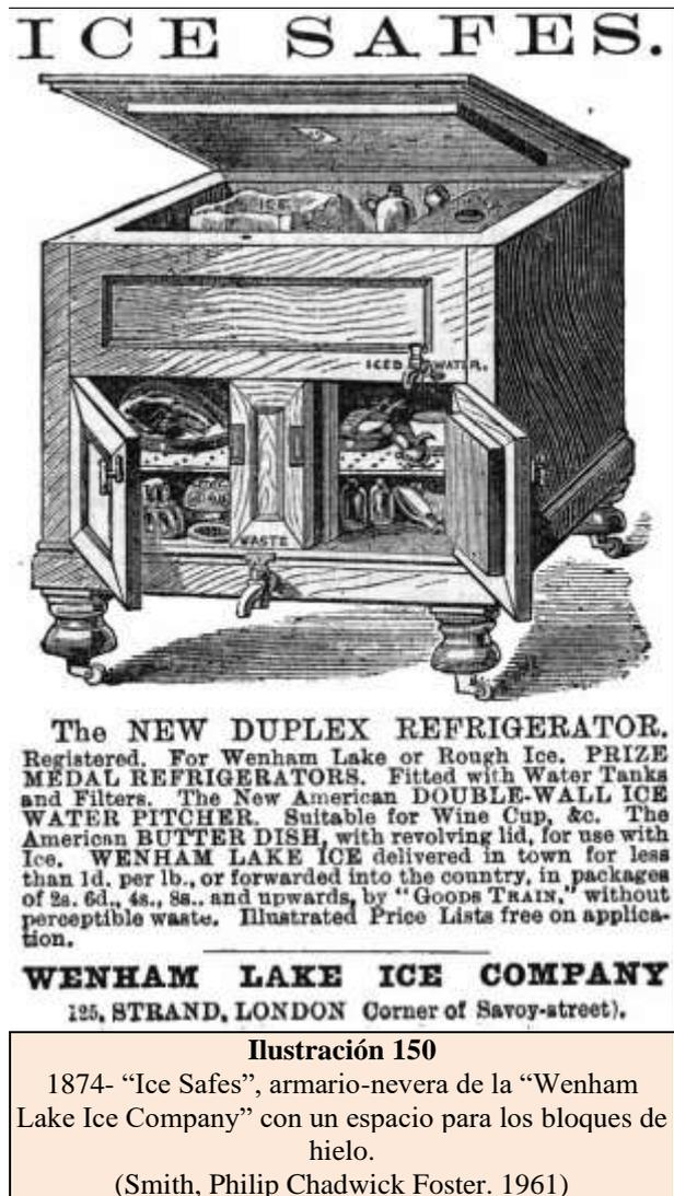
Las "modernas neveras (icebox o cold-closet)" consistían en armarios de madera, forrados interiormente de zinc, con una capa aislante intermedia de corcho y unas puertas con juntas de goma para hacerlas estancas. Disponían de varias estanterías y compartimentos (Ilustración 151).
