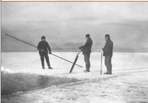
1913- Útiles para la cosecha del hielo: Sierra de hielo, gancho de hielo y barra para separar los bloques de hielo.
